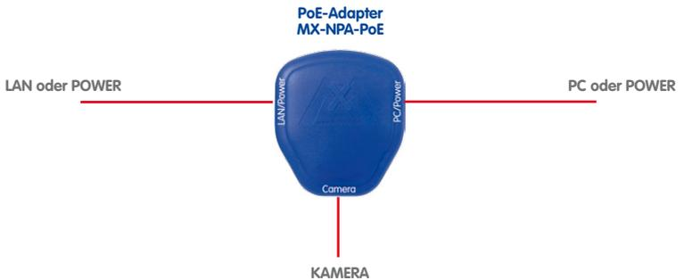
Verwenden Sie für die D15D das blaue MX-NPA-PoE-Set – das bisherige MOBOTIX-Netzwerk-Power-Zubehör NPA-Set, Power-Box und Power-Rack (MX-NPA-Set, MX-NPR-4 und MX-NPR8/20) ist für den Einsatz der D15D nicht geeignet
