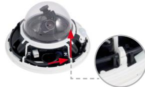
8. **Lage der Kabel kontrollieren:** Die beiden Kabel sollten jetzt vor den Anschlussbuchsen über Kreuz verlaufen.
