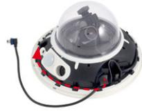
6. **USB-Stecker einstecken:** Stecken Sie den MiniUSB-Stecker in die entsprechende Buchse. Achten Sie auch darauf, dass das Kabel korrekt in den Kabelführungen liegt und dass kein überschüssiges Kabel vor den Anschlüssen liegt.
