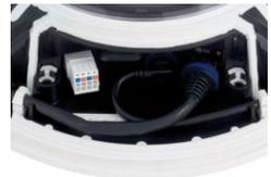
9. **Kabelabdeckung montieren:** Setzen Sie die Kabelabdeckung wie gezeigt ein und schrauben Sie die beiden Inbusschrauben M4x25 wieder fest. Achten Sie bei der Montage der Kabelabdeckung auf einen korrekten Abschluss mit der Dichtung am Gehäuse und an den beiden Kabeldurchführungen. Nur so ist sichergestellt, dass die Anschlüsse optimal gegen Witterungseinflüsse geschützt sind.
