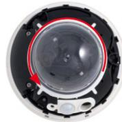
3. **Einsetzen und Fixieren der Objektivseinheiten:** Entfernen Sie die mittlere Halteschraube und die Unterlegscheibe. Setzen Sie die Objektivseinheiten in die Führungen ein. Fixieren Sie anschließend die Objektivseinheiten mit der Halteschraube und einer Unterlegscheibe in der Kameramitte.
